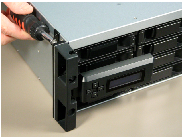
Рис. 8. Установка ЖК-панели на корпусе VessRAID
