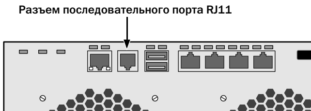
Рис. 24. Разъем последовательного порта находится на контроллере
